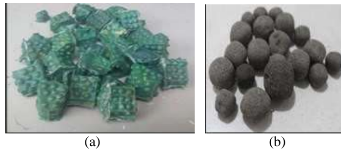
Gambar 1. Agregat plastik PP: (a) bentuk agregat plastik tanpa pelapisan (Pamudji,G. dkk.,2013), (b) agregat plastik setelah dilapisi pasir
