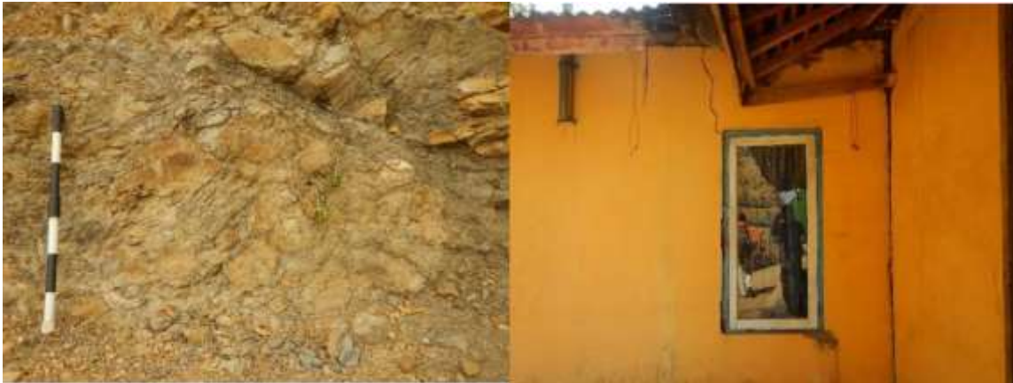
Gambar 2. Atas: Singkapan batulempung-batupasir pada daerah penelitian. Bawah-kanan: Retakan pada rumah yang tepat berada di bawah singkapan. Bawah-kiri: memperlihatkan kekar yang intens pada batuan.
