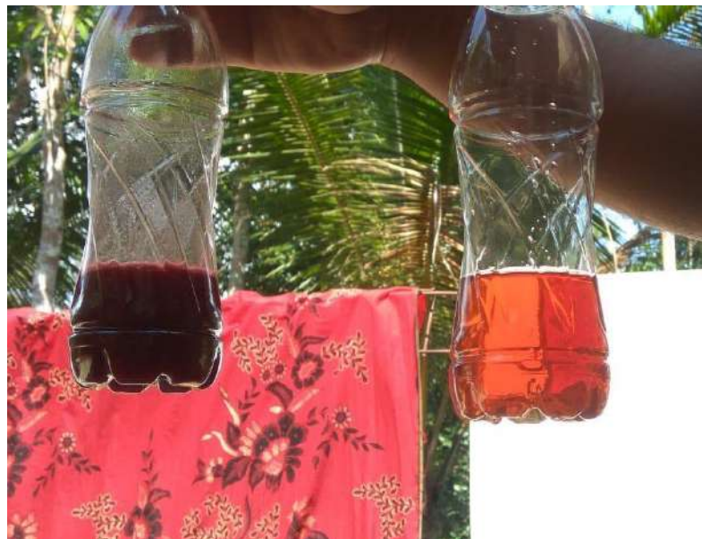
Gambar 2. Hasil pengolahan limbah cair batik (kiri = sebelum, kanan = sesudah)
