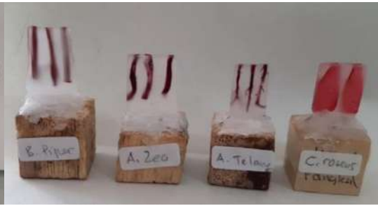
Gambar 2. Blok parafin berisi organ batang dan daun yang siap diris dengan mikrotom rotary.
